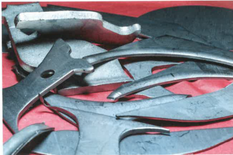
Bild 1: Gereinigte Stanzabfälle haben das Potenzial, die Kosten zu senken sowie Prozess- und Arbeitssicherheit zu erhöhen.
